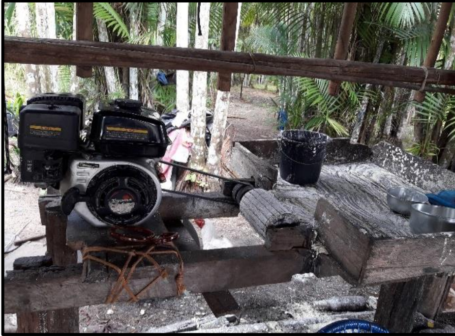
Figura 11: Máquina de catitu ou gerador – usado para triturar a mandioca.
